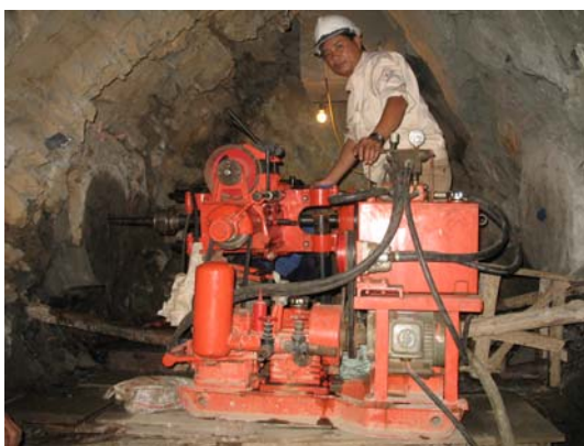
Khoan xoay lấy mẫu tạo lỗ khoan giãn kế trong hầm ngang
