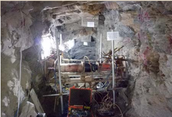
► Thí nghiệm cơ địa trong hầm ngang bằng phương pháp giãn kế
