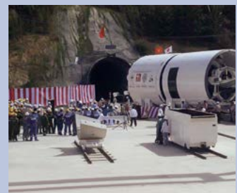
Công nghệ đào hầm bằng TBM lần đầu tiên tại VN, tại NMTĐ Đại Ninh (2x150MW, H=627m), đường hầm dài nhất VN (11km).
